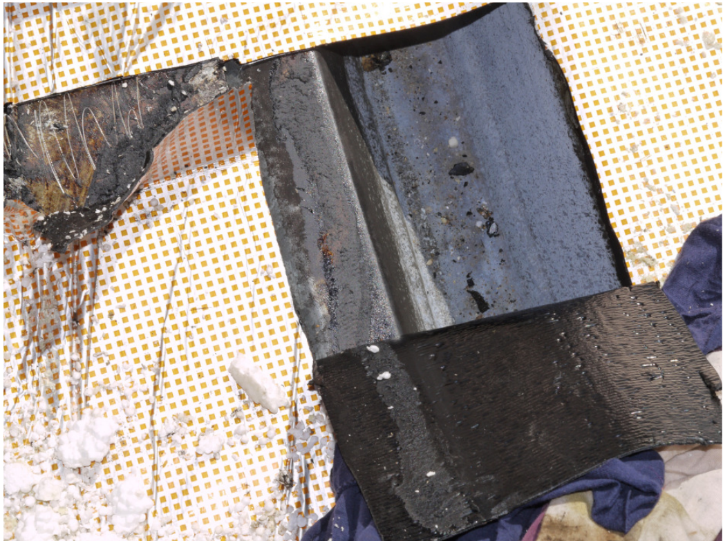
Nahezu vollständig hydrolysierte Zinkschicht 15
