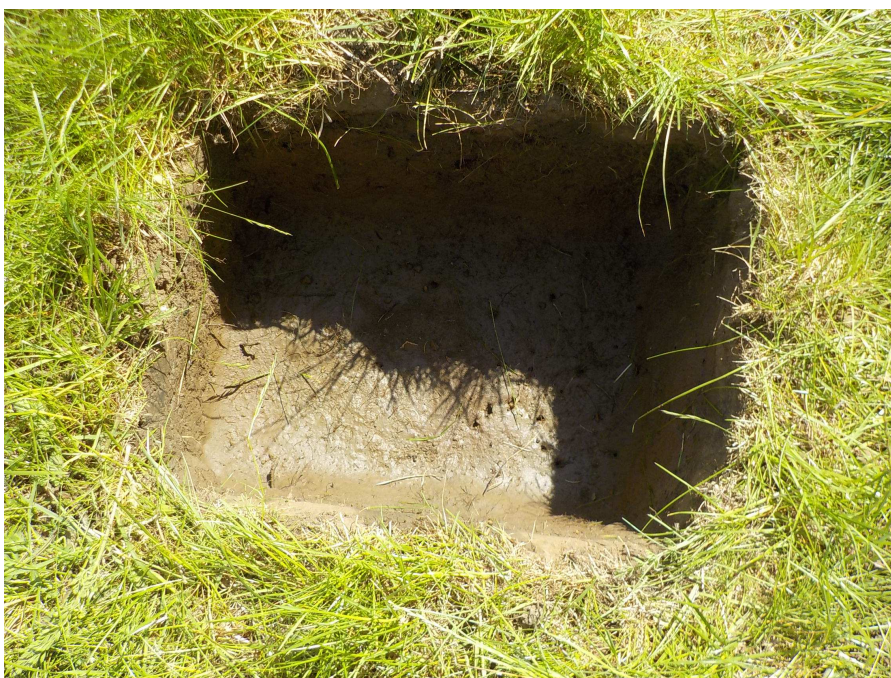
Foto 4: Komplett ausgehobene Testmulde
