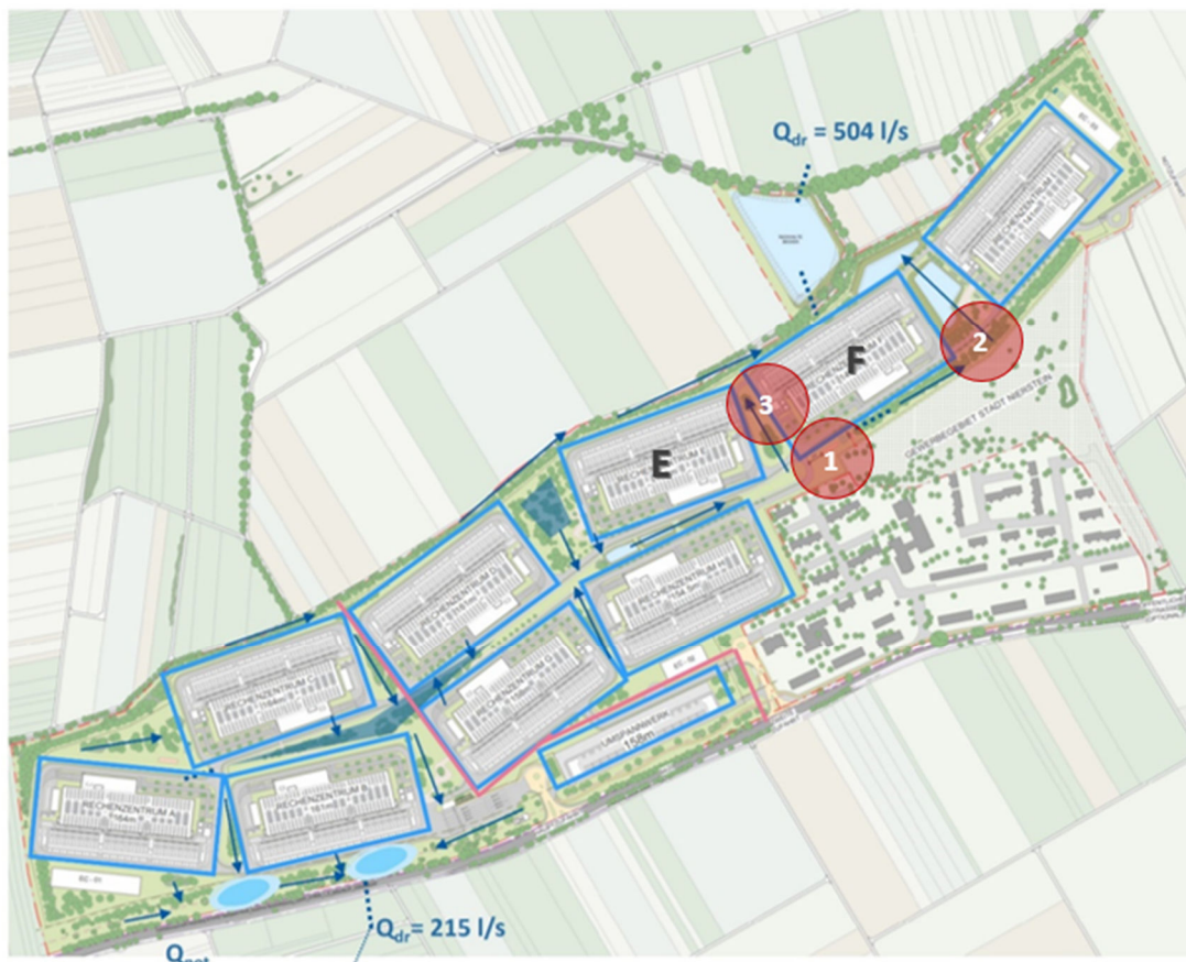
Abbildung 30: Kritische Punkte in der Entwässerung (rot markiert) - Masterplan Layout modifiziert durch D&S, Stand 04.04.2025 (Quelle: MCA Architects und TTSP HWP Planungsgesellschaft mbH, 2024)
